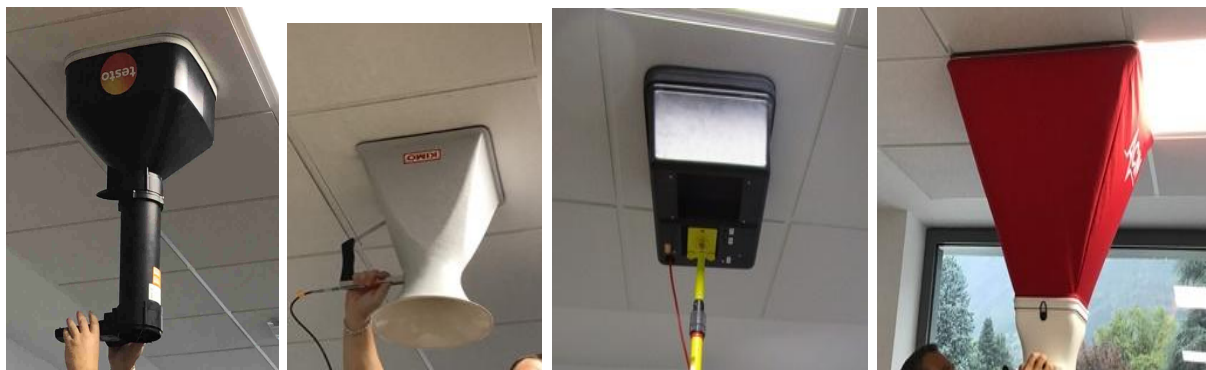
Figure 8 : Bâtiment 1 salle EG01-207 – mesures aux terminaux avec 4 appareils de mesure
